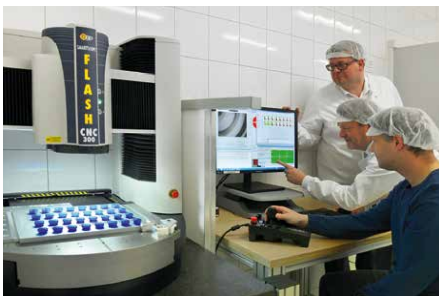
Bild 1. Verwaltet und bedient werden die gut 350 Prüfprogramme über die Benutzeroberfläche Smart SCS, basierend auf der Systemsoftware MeasureX. OGP-Spezialisten Jörg Spielmann und Stefan Weber sowie QS-Mitarbeiter Mike Fritz erläutern die Vielfalt der Softwarefähigkeiten (v.l.n.r.).
