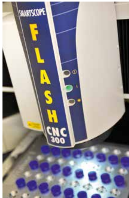
Bild 2. Mit seiner Kombination aus patentiertem LED-Durchlicht für numerische Apertur, LED-Koaxiallicht und ebenfalls patentierter SmartRing-Beleuchtung deckt das Videomesssystem genau das Anforderungsprofil bei der Messung von Kunststoffteilen ab.
