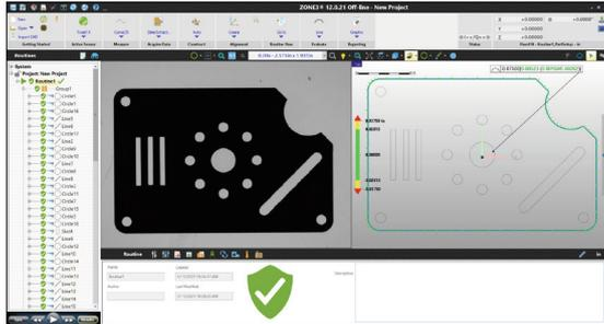
ZONE3 verwendet innovative Funktionen, um automatische Messroutinen zu erstellen. Die gleichzeitige Messung- und Verarbeitung identischer Merkmale im Bildfeld in Kombination mit einer intelligenten Optimierung der Messgeschwindigkeit sind weitere Vorteile von ZONE3.
