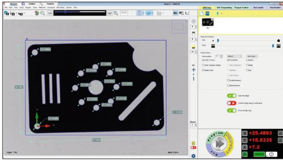
SNAP-X bietet eine einfache und leistungsstarke Oberfläche für sofortige 2D-Messungen und die automatische Programmerstellung, sowie umfassende Form- und Lage-Berechnungen. Mit den simplen "Punkt- und Klick"-Funktionen können alle Merkmale an einer Vielzahl von Teilen identifiziert und einfach programmiert werden. Nutzen Sie virtuelle Lehren und Profileinpassungen, sowie die integrierten Report- und Exportfunktionen, um Ergebnisse leicht und schnell anzuzeigen.
